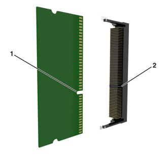
**4** Empurre o cartão de memória em ângulo reto com o conector e depois empurre o cartão de memória na direção da parede da placa do controlador até emitir um *clique*, indicando que encaixou no lugar.
