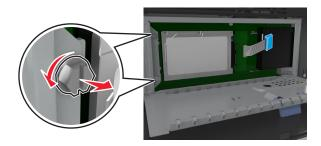
**3** Desconecte o cabo de interface do disco rígido da impressora do receptáculo na placa de controle, deixando o cabo conectado ao disco rígido da impressora. Para desconectar o cabo, aperte a pá no plugue do cabo de interface para soltar a trava antes de retirar o cabo.
