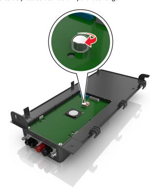
**7** Aperte os dois parafusos na extremidade da solução ISP.
