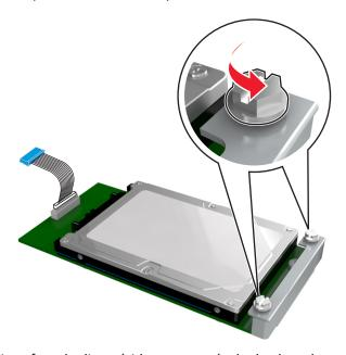
**b** Insira o plugue do cabo de interface do disco rígido no receptáculo da placa de controle.
